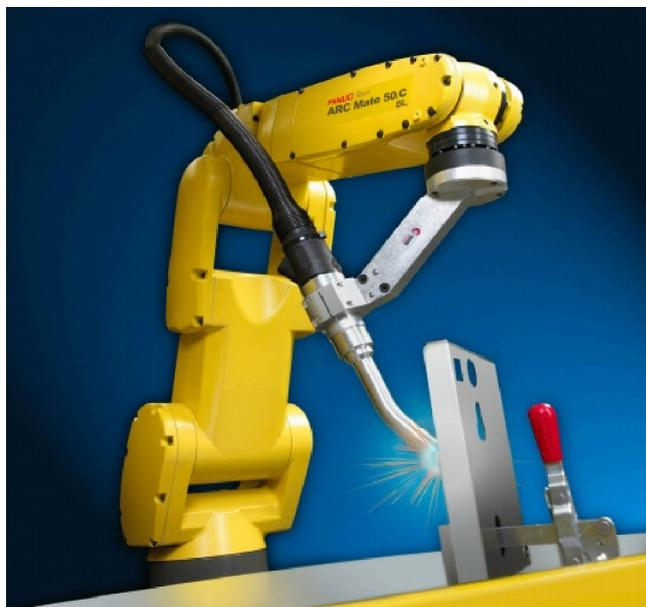
شکل ۶-۴۹: ربات FANUC ARC Mate<sup>®</sup> 50iC/5L
